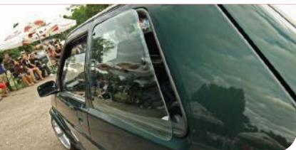
Démontez la vitre avant de poser le film. Posez le film, puis coupez légèrement plus large autour des trous du film (1). Séchez le film à l'aide d'un sèche-cheveux. Une fois le film sec, remontez la vitre.
