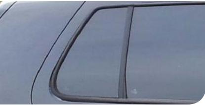
Il est conseillé de couper le joint : pour cela, avec un cutter, retirez 1 à 2 mm de joint sur tout le tour. (1)
